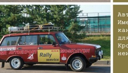
Автомобиль технической службы команды «Советское ралли». Имеет дополнительный грузовой багажник для перевозки запасных колес и канистр с топливом, а также специальное оборудование и инструменты для обслуживания спортивных автомобилей «Москвич» на трассе ралли. Кроме того, имеется «жесткая сцепка» для буксировки автомобиля с неисправной тормозной системой и рулевым управлением.
