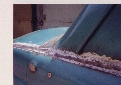
МЗМА были ими вооружены. На новое место проем заднего стекла и часть панели крыши приварили не уродующий металл газовой сваркой, а полуавтоматом «кемпи».
